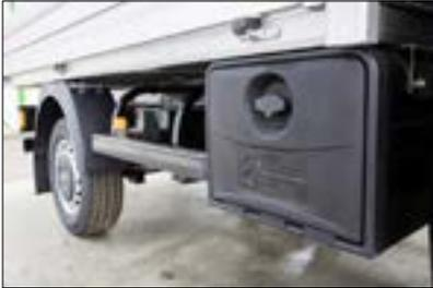
Plastik Staukasten am Fahrwerk - EU genehmigt mit Befestigungshalter geliefert
