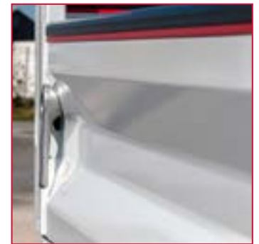
Doppelte Sicherheit und in die Bordwand integrierter Griff zur Vermeidung unbeabsichtigten Öffnens durch Hängenbleiben
