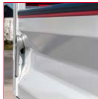
Doble seguridad con tirador integrado en la compuerta, que evita aperturas imprevistas debidas a enganches
