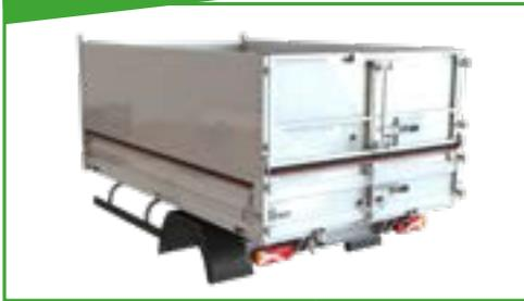
Rehausse arrière à 2 vantaux tôle pleine aluminium
