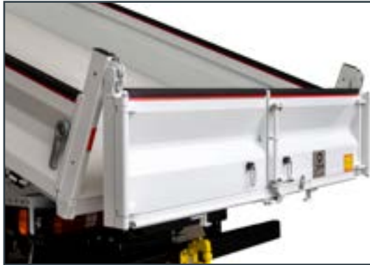
Porte à décrochage automatique
