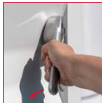
Double sécurité et poignée intégrée dans la ridelle évitant ainsi les ouvertures intempestives par accrochage
