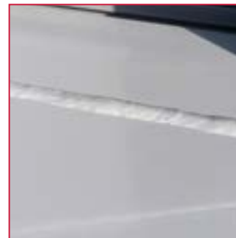
Soudure cordon MIG robotisée
