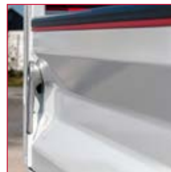
Double sécurité et poignée intégrée dans la ridelle évitant ainsi les ouvertures intempestives par accrochage
