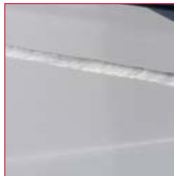
Soudure cordon MIG robotisée
