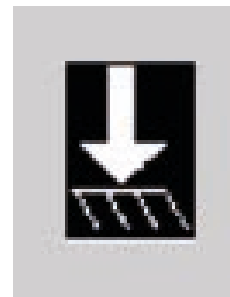
Touche DOWN : descente de la benne
