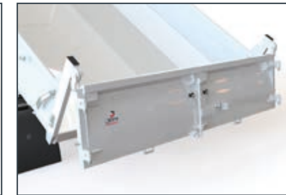
= Portello a sganciamento automatico +
