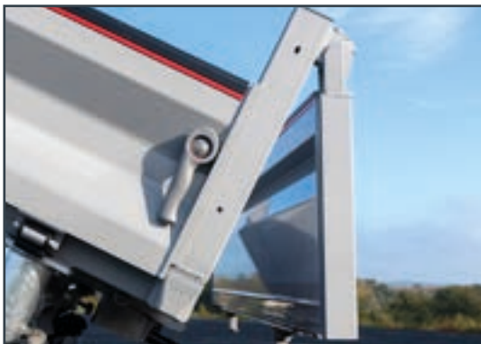
= Portello a sganciamento automatico
