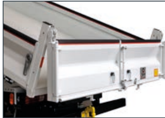
= Deur met automatische afkoppeling
