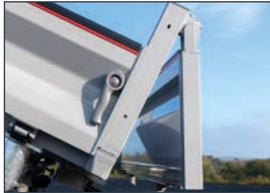
= Deur met automatische afkoppeling
