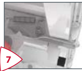
Betrouwbaar openen van de deur Rechtstreekse verbinding tussen de kipper en de haak
